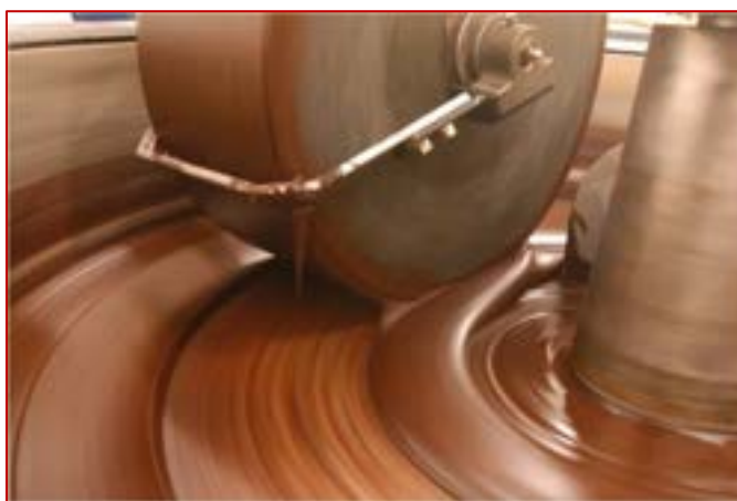
Photo 2-5 : Broyeur de fèves
