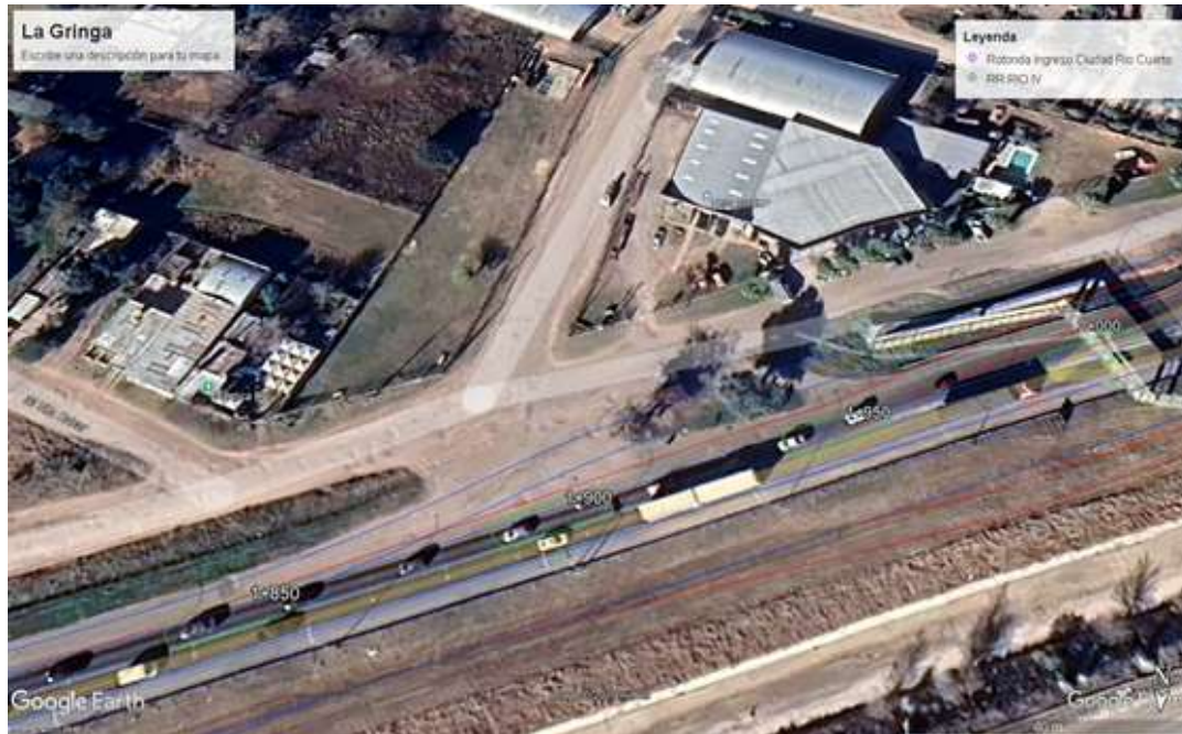
Ilustración 19: Duplicación de calzada sobre ruta A005, afectación sobre puesto La Gringa
