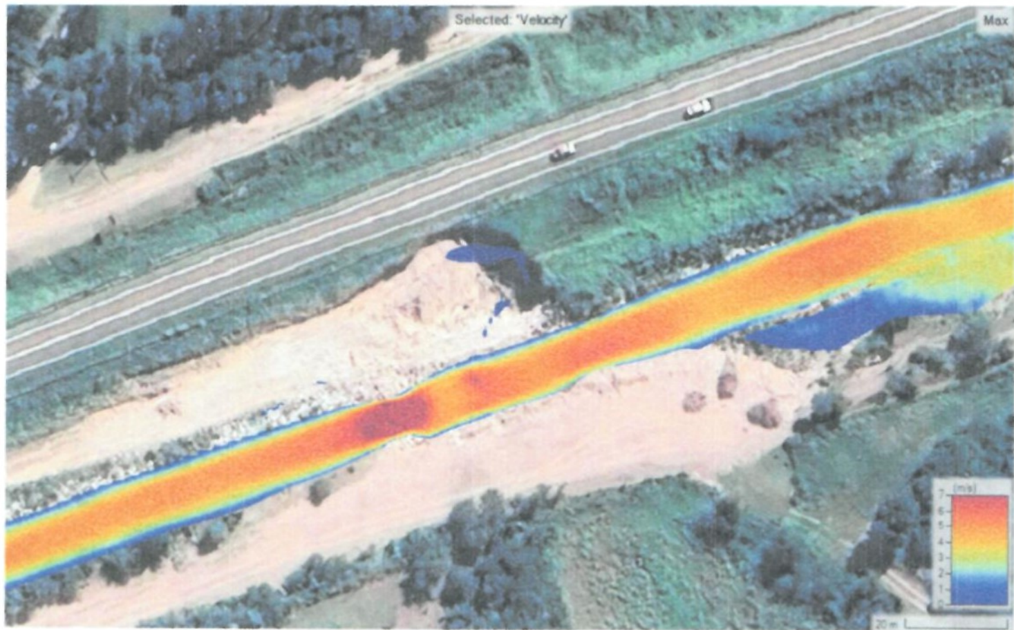
Figura 26: Vista de Planta de la modelación hidráulica para el escenario actual. Tormenta de Diseño: 50 años de Recurrencia
