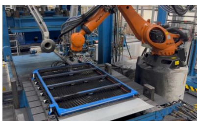
Nakładanie spoiwa w spray
