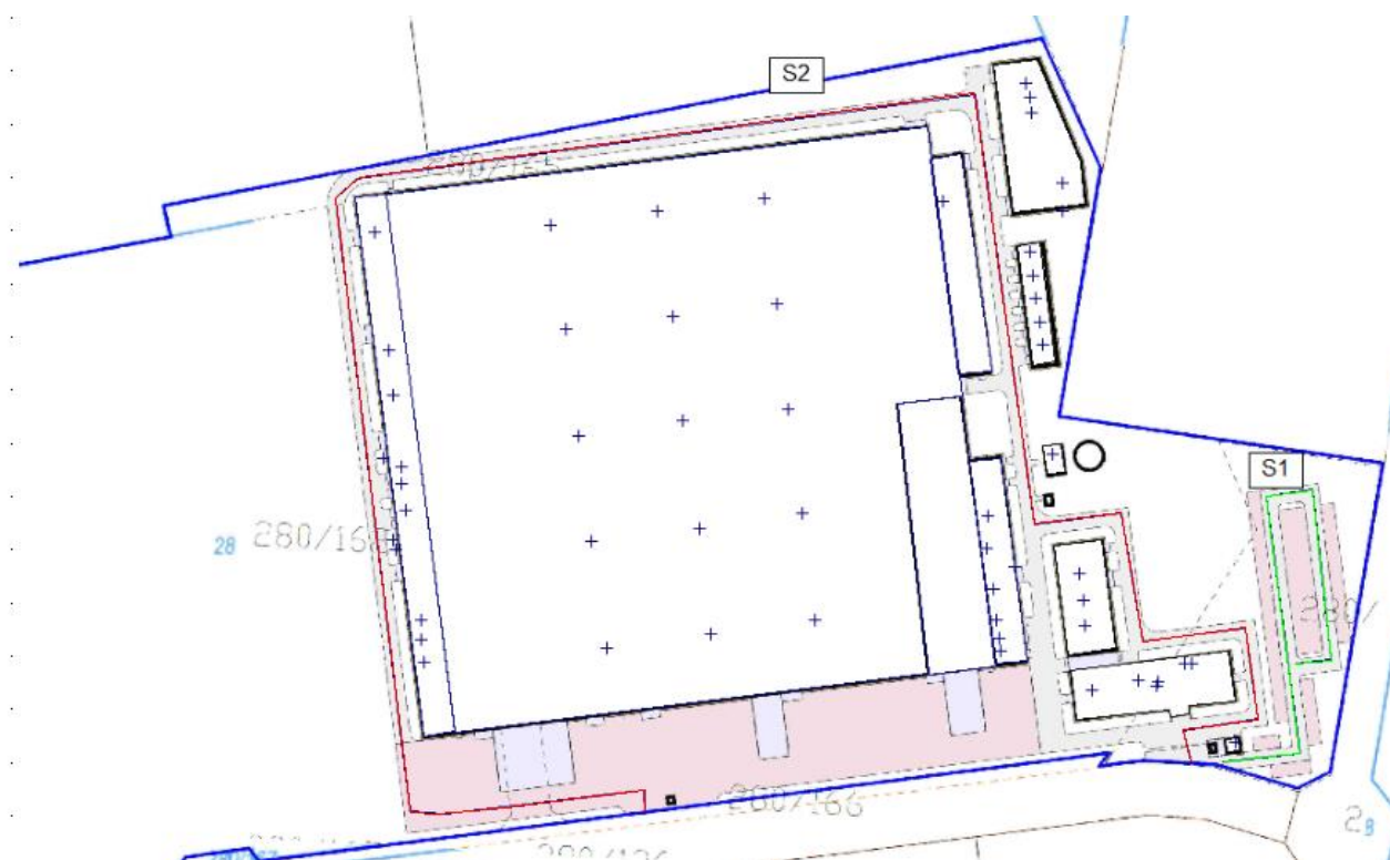
Rysunek 11. Lokalizacja odcinków dróg wprowadzonych do programu S1 – kolor zielony, samochody osobowe S2 – kolor czerwony, samochody ciężarowe
