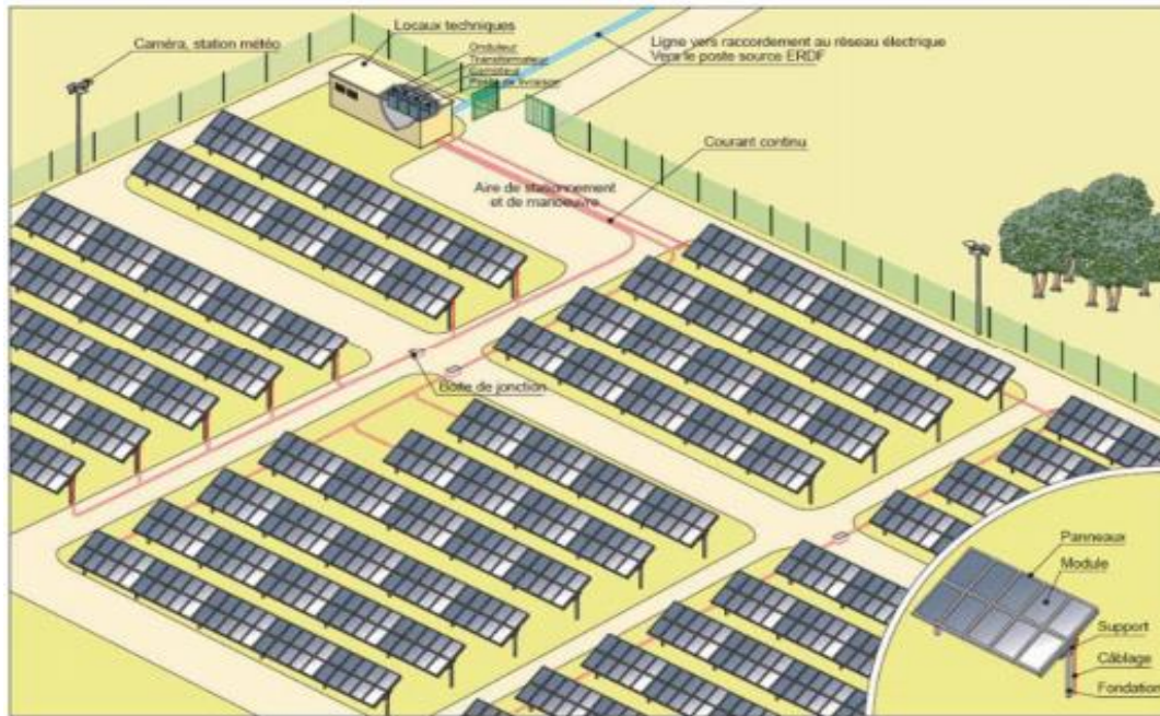
Figure 10: Schéma de fonctionnement d'une installation type photovoltaïque
