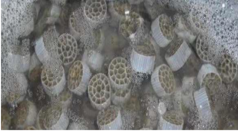
شكل (24). قطع بلاستيكية على شكل اسطواني من البولي بروبيلين (MBBR Media).
