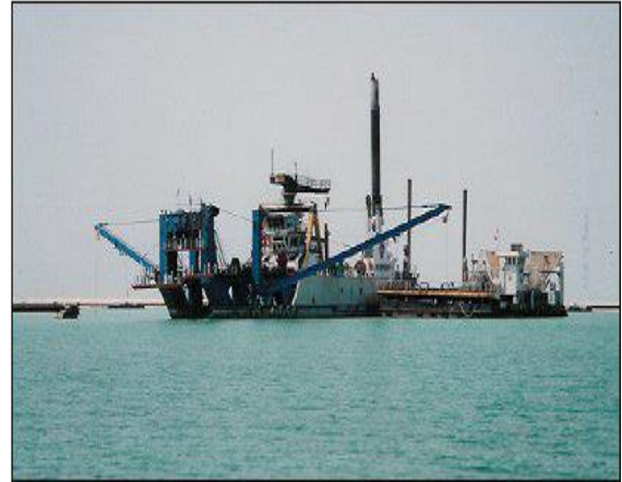
شكل ( 9-2 ) الحفارة ذات الشفط القاطع (CSD) الأنابيب العائمة المستخدمة لنقل المواد المجروفة
