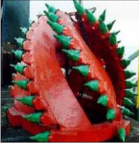
شكل ( 2-14 ) راس تقطيع لبعض أنواع حفارات التركيب.
