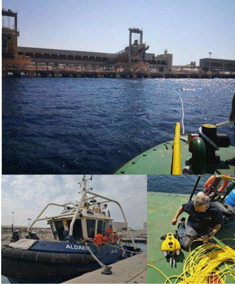
الشكل 40: جهاز بالمركبة الغواصة المسيّرة عن بُعد ROV والقارب المستخدم لإجراء المسح العميق بالفيديو
