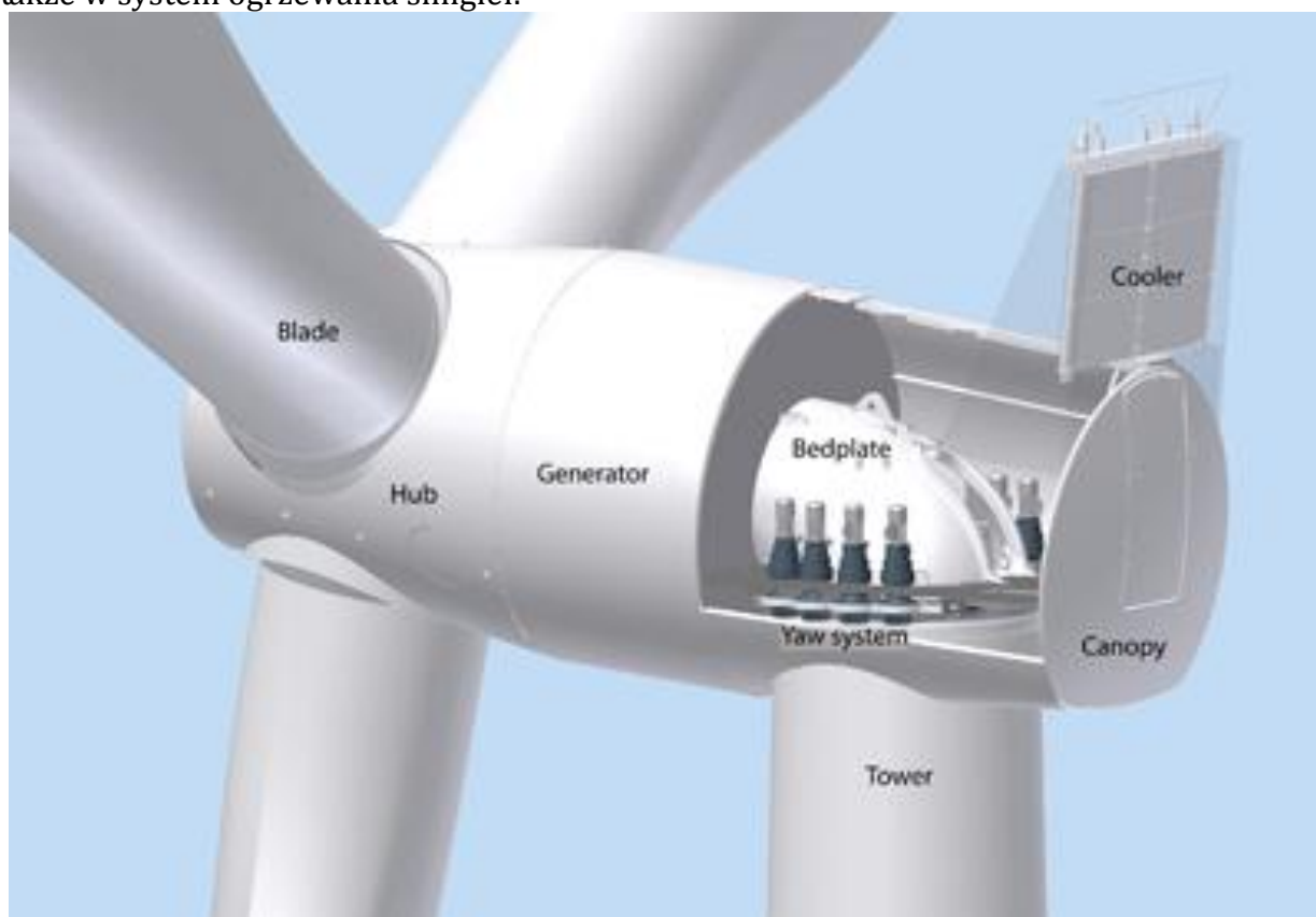
Rysunek 1. Budowa turbiny Siemens SWT-3.0-101 DD
