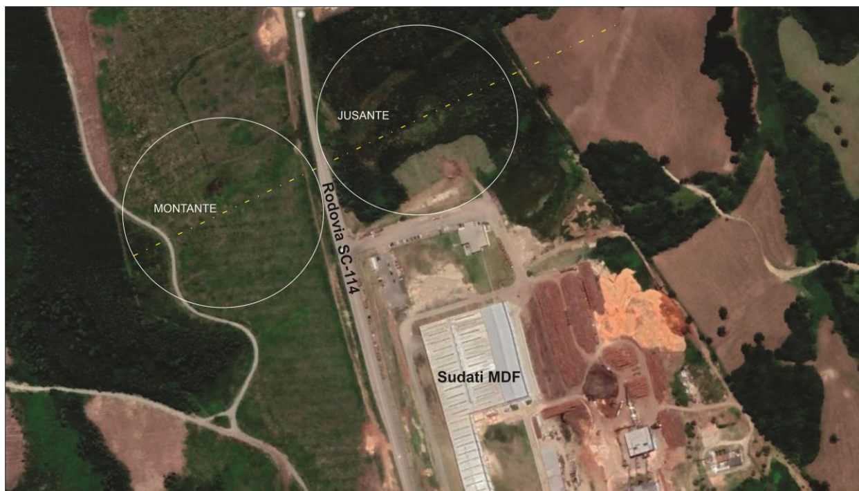
Figura 16. Eixo do talvegue (linha pontilhada amarela) que foi obstruído pelo aterro da Rodovia SC-114 separando a parcela montante da parcela jusante.
