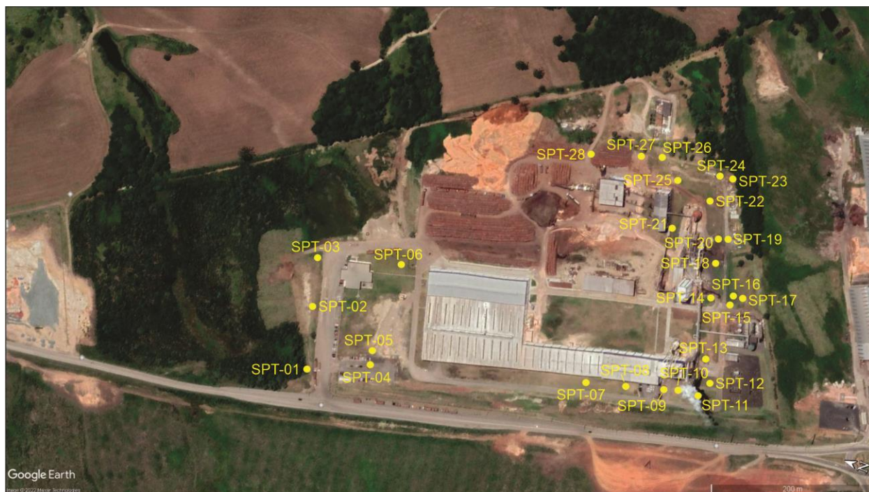
Figura 7. Indicação dos pontos onde foram executadas as sondagens do tipo SPT na área de estudo e nas áreas já ocupadas pela indústria SUDATI.
