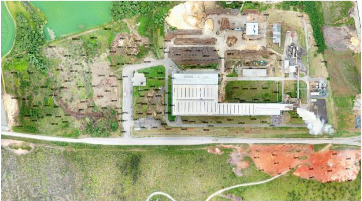
Figura 8. Indicação dos pontos onde foram executadas as sondagens do tipo CBR para os projetos executivos.
