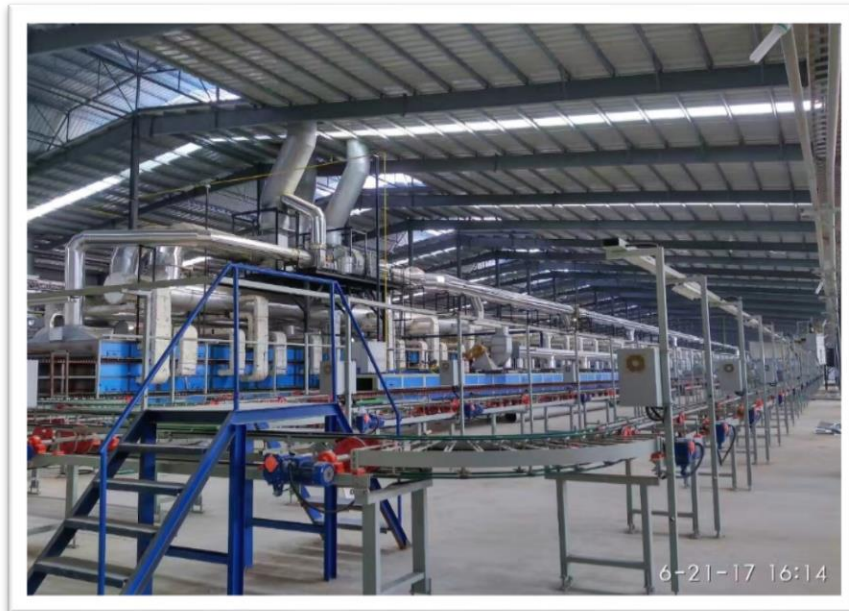
Photo 17 : Ligne de faïence pour décoration des carreaux
