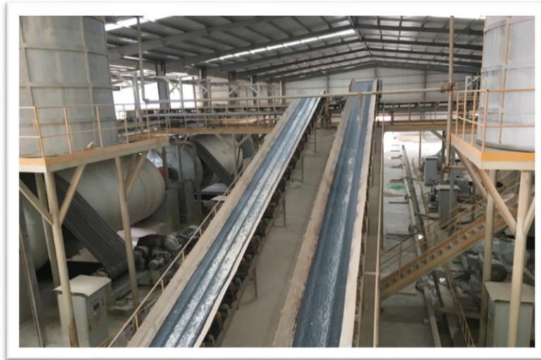
Photo 12 : Convoyeur principal pour le transport des matières premières
