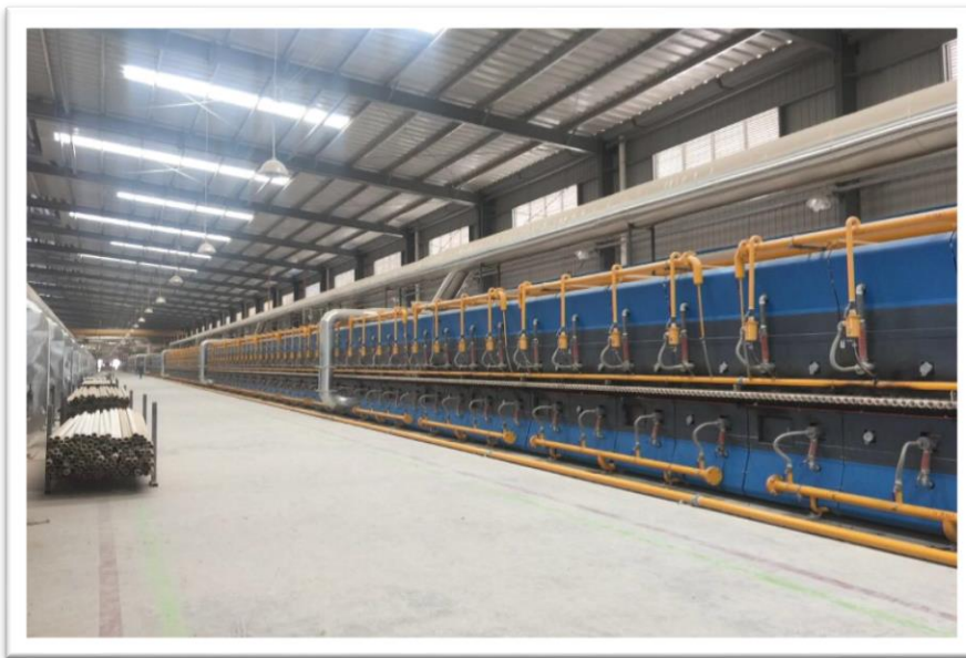
Photo 18 : Four à rouleaux pour la cuisson des carreaux
