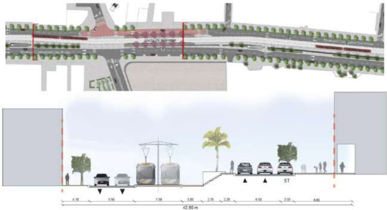
Figure 6 : vue en plan et coupe sur le boulevard Mohammed VI
