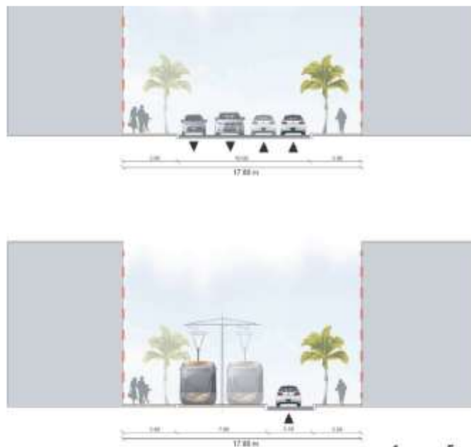
Figure 5 : Insertion latérale au niveau de boulevard Rachidi côté Ouest
