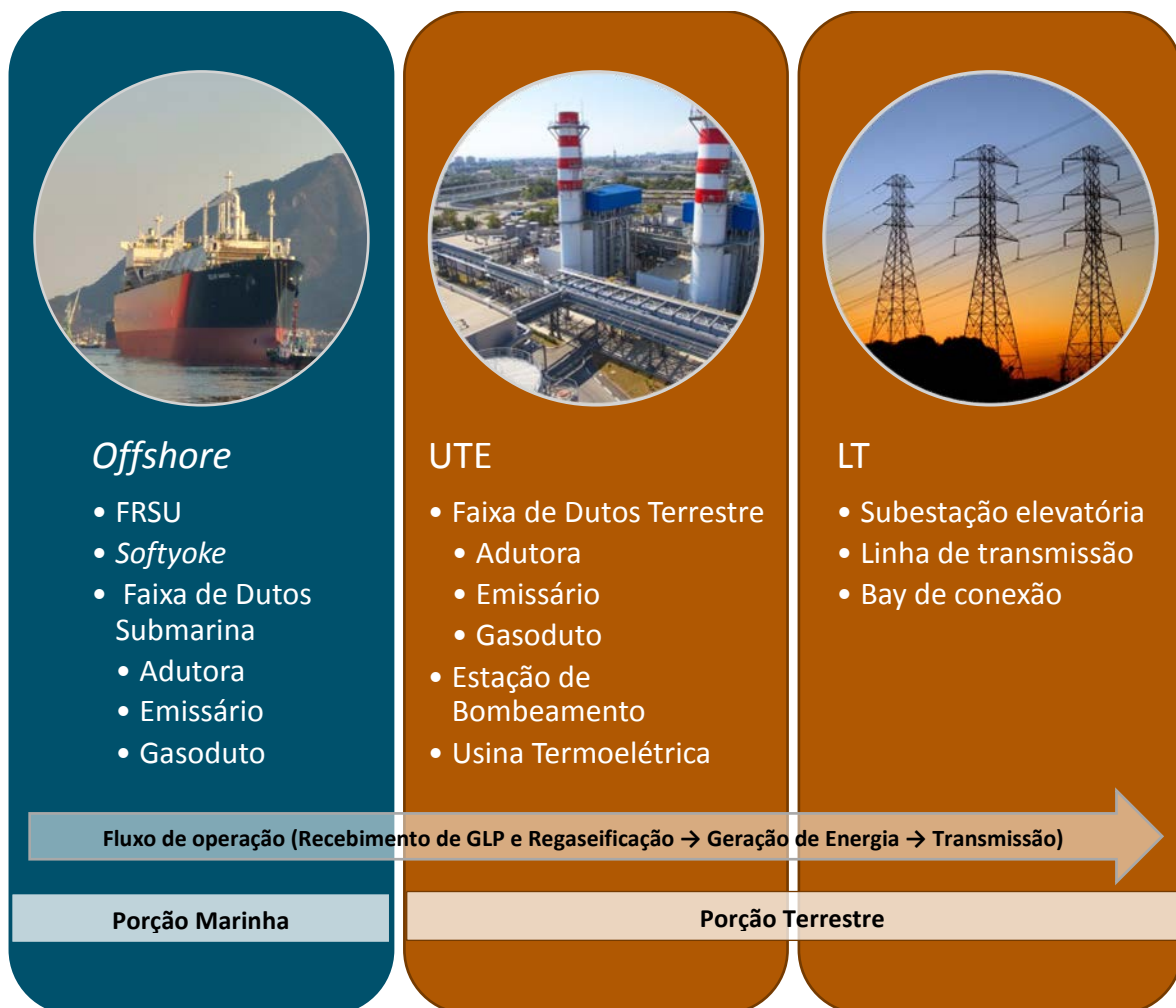
Figura 2: Diagrama das estruturas que compõem as unidades do Complexo Termoelétrico Porto de Sergipe I
