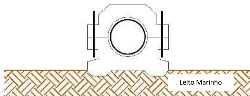
Figura 3.2-15: Seção transversal ilustrativa do trecho final, onde os dutos serão assentados sobre o leito marinho
