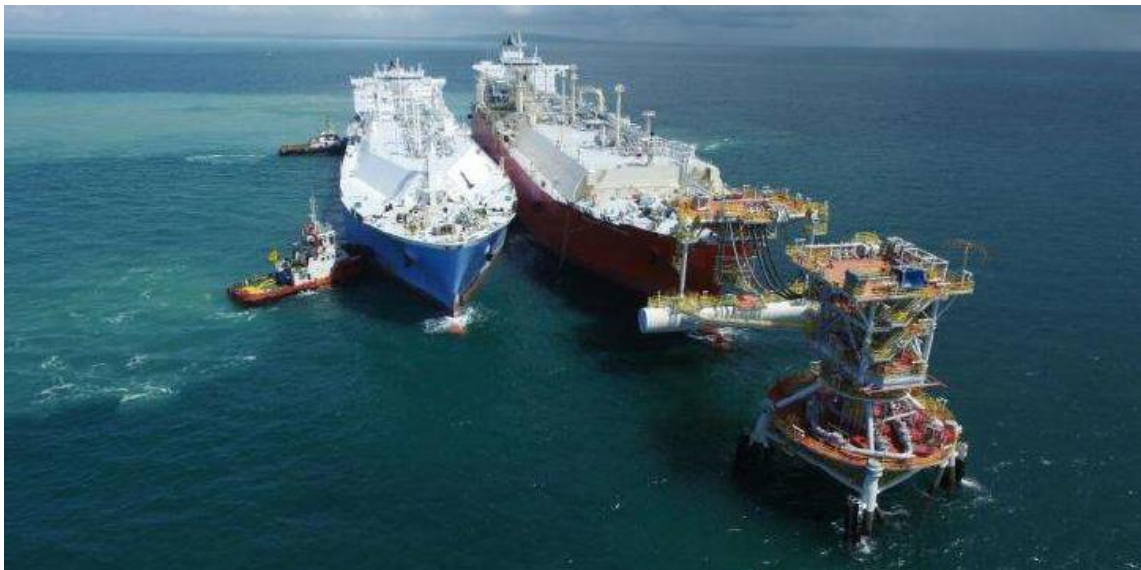
Foto 3.1-2: Operação de atracação a contrabordo de navio metaneiro a um FSRU ancorado a um yoke em torre
