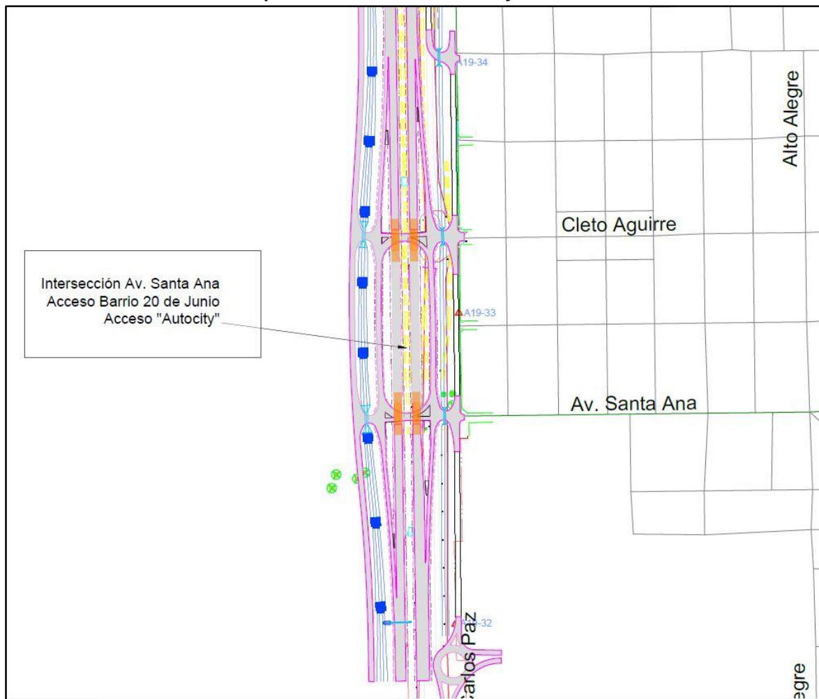
Ilustración 4 Distribuidor que vincula la Av. Santa Ana y el Acceso al barrio 20 de Junio
