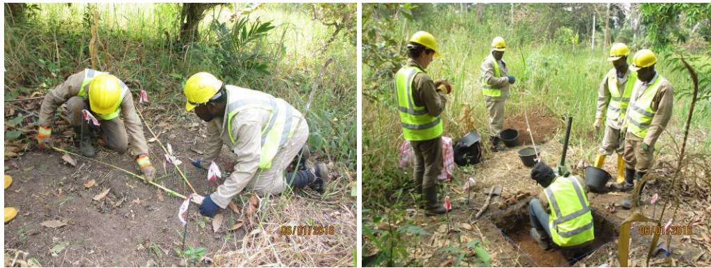
Photo 54 : Implantation et fouille du Test Pit NAC/C/007.
