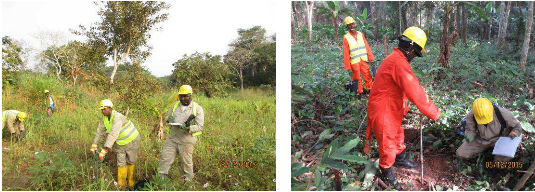
Photo 2 : Tarières manuelles sur l'aire des entreprises/carrière
