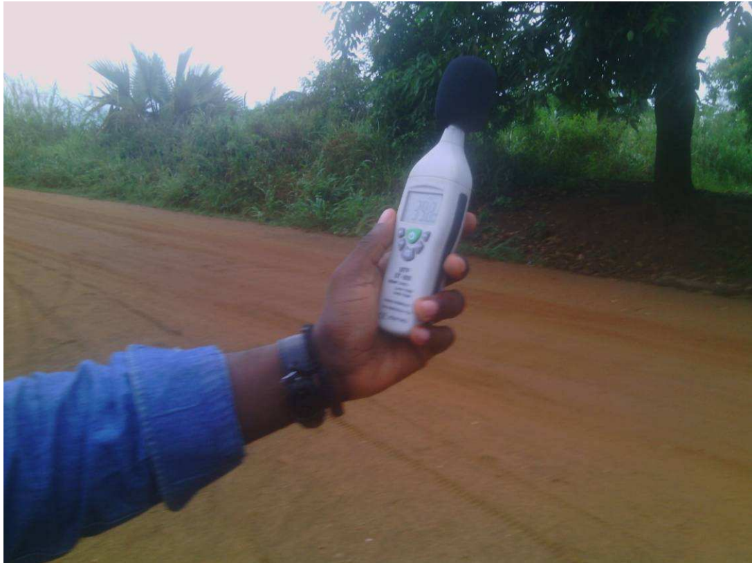
Figure 1 : Sonomètre de marque MTP de modèle ST-805, No Série 2170189
