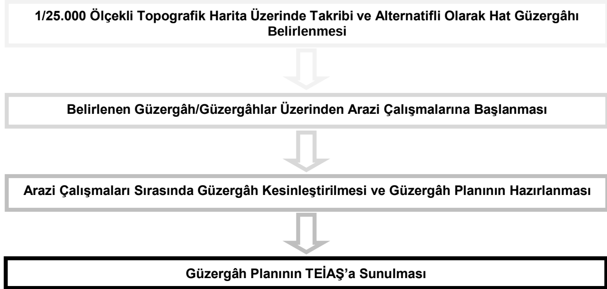
Şekil 7. Enerji İletim Hattı Güzergâh Seçimi İşlemleri
