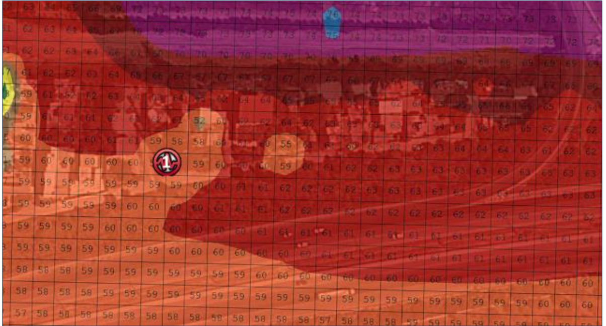
Şekil 10-9: Konum 1'i ve Faz 2 için etrafındakileri gösteren ayrıntılı yatay grid haritası (yer düzeyinden 4 metrelik bir yükseklikteki gürültü düzeyleri)
