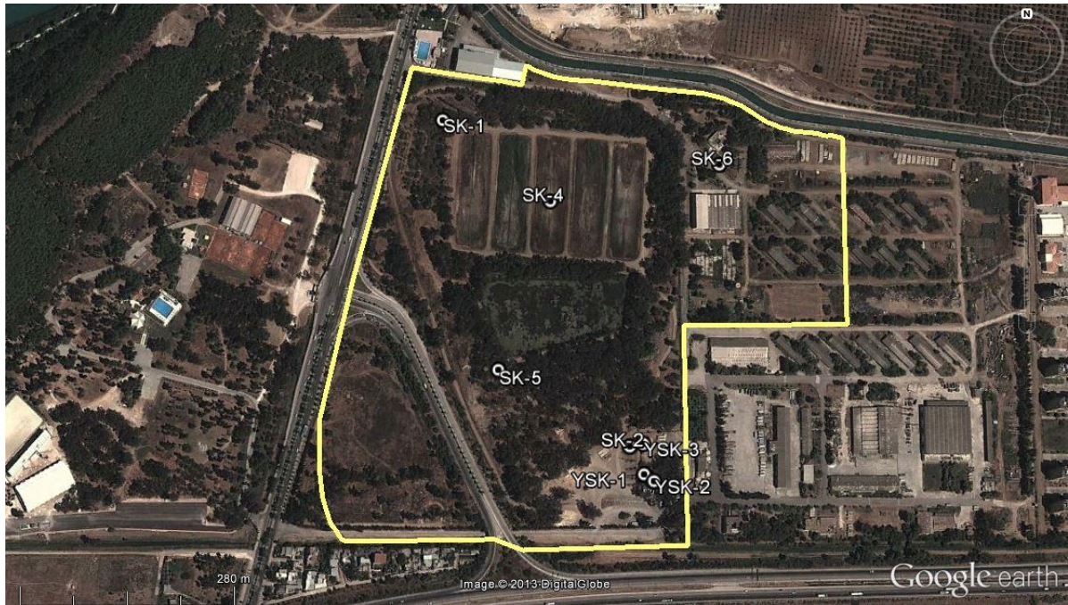
Şekil 6-11: Numune alma noktaları (SK-1 ve SK-2 (20 m yer altı suyu izleme kuyusu), SK-4' den SK-6' ya sığ sondaj kuyuları (maksimum derinlik 1.5 m), YSK-1' den YSK-3'e DSİ bakım sahasında sığ toprak numuneleri)
