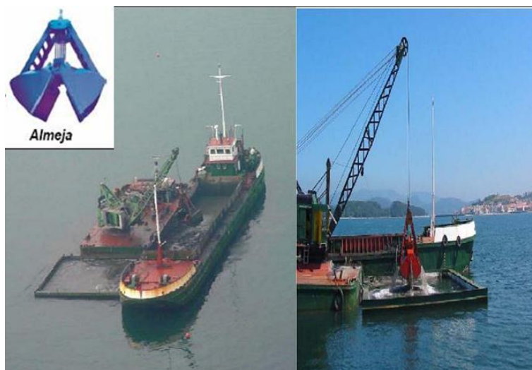
Foto 5. Draga Mecánica, Montada sobre Planchón, Barcaza y Cucharón Tipo Almeja
