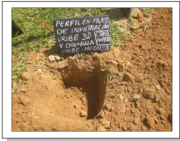
Fotografía 2-63. Perfil 1 en prueba de infiltración
