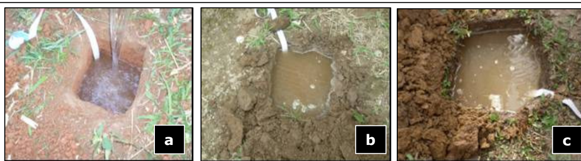
Fotografía 5-8. Prueba de infiltración (a) Vereda Buenos Aires; (b) Caserío Puerto Rosario; (c) Vereda Samaritana
