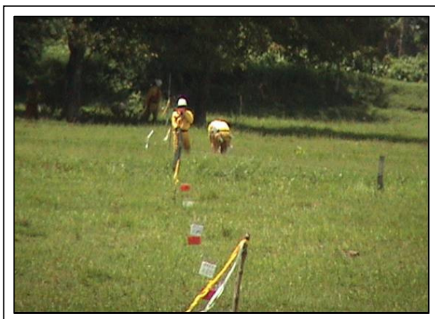
Fotografía 5-4. Señalización tipo de las líneas sísmicas
