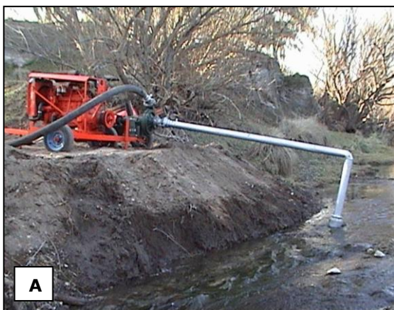
Fotografía 4-2. Sistema de captación y conducción de agua potable. A) Motobomba y manguera. B) Carrotanques.
