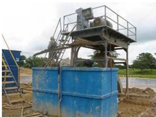
Fotografía 7-4. Unidad dewatering tipo empleada en pozo
