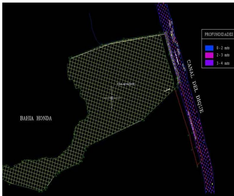
Figura 3.2.8. Batimetría zona del canal del Dique
