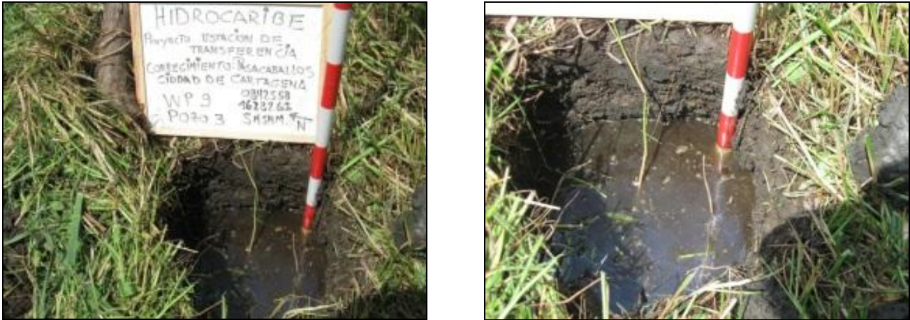
Figura 1.6.26. Anegamiento de los pozos de sondeo
