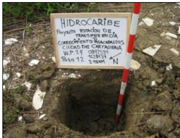
Figura 1.6.31. Pozo de sondeo No 12 sobre basurero en zona seca del lote
