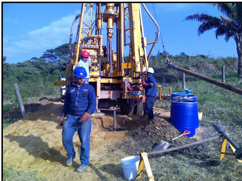
Foto 26. Perforación con el penetrometro para verificar la profundidad del nivel estático de agua.
