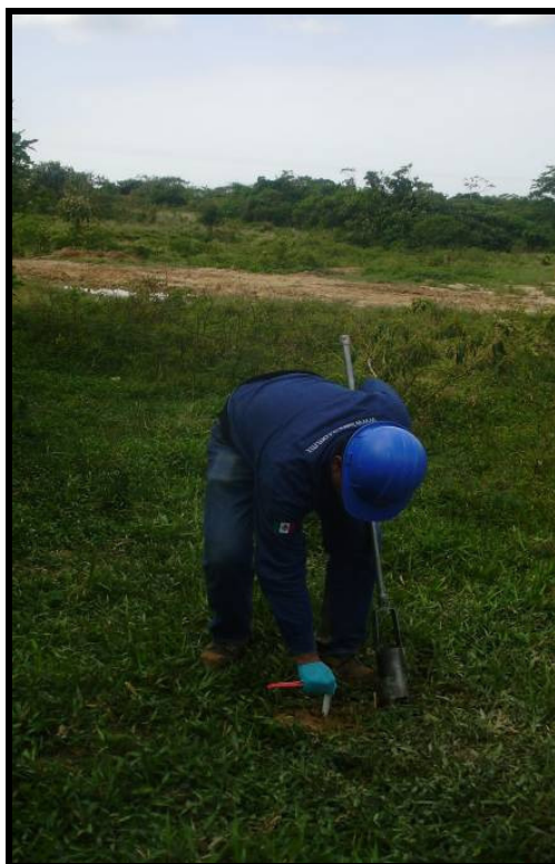
Foto 10. Vista final del relleno sondeo SB-3.
