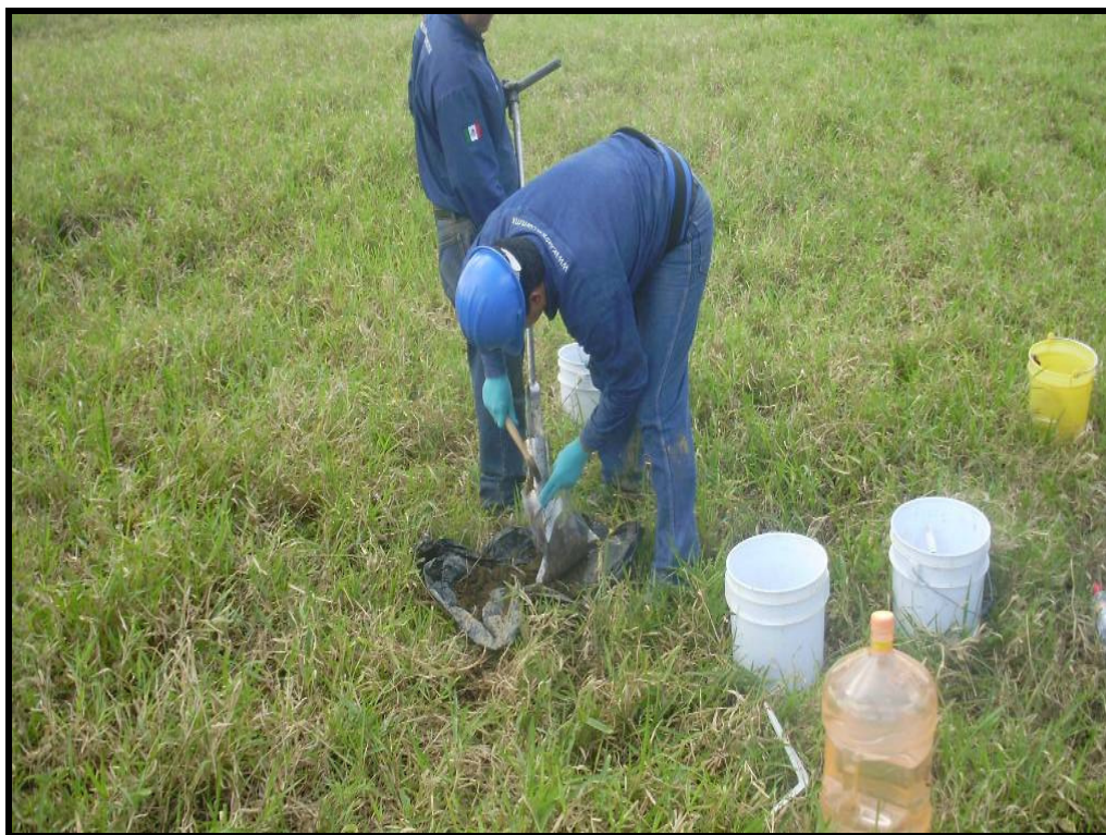
Foto 24. Puntos de verificación para descartar instalaciones subterráneas (SB-12).
