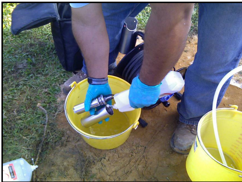
Foto 46. Toma de muestra con el equipo de bajo flujo en el pozo SB-13/MW-2.
