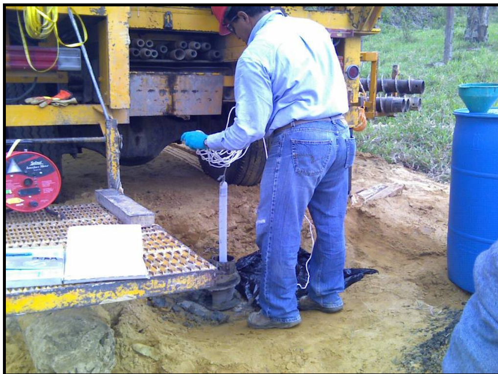
Foto 32. Toma de muestra de agua con el equipo de bajo flujo en el pozo SB-12/MW-1.
