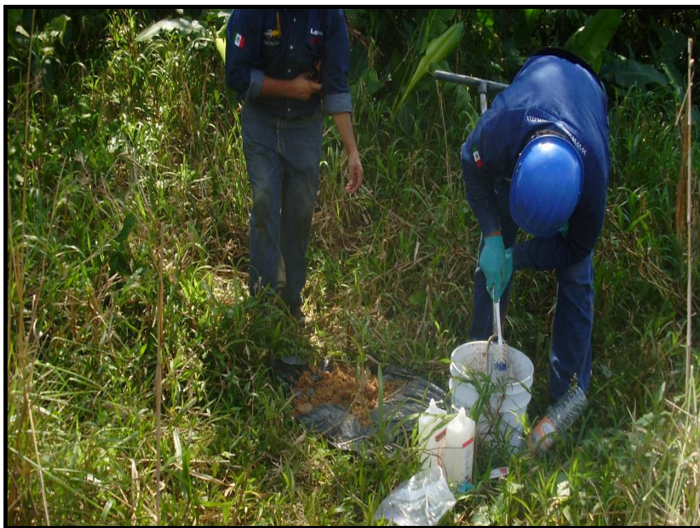
Foto 6. Toma de mediciones con el equipo de detección de vapores (PID).
