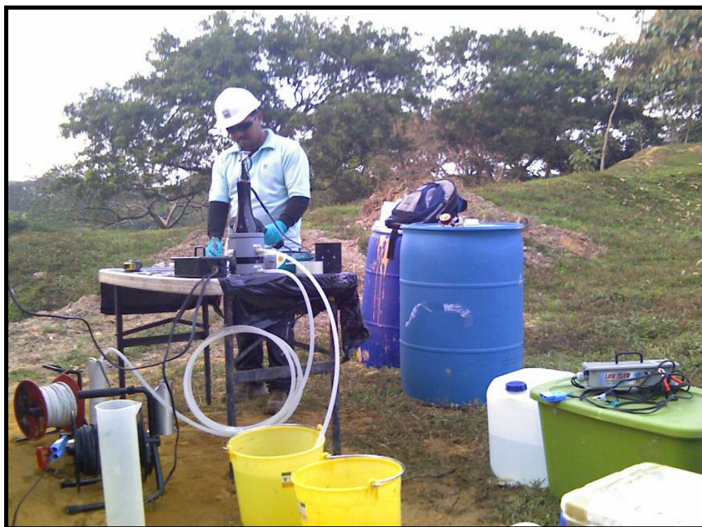
Foto 46. Toma de muestra con el equipo de bajo flujo en el pozo SB-13/MW-2.
