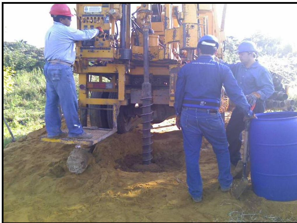
Foto 26. Perforación con el penetrometro para verificar la profundidad del nivel estático de agua.
