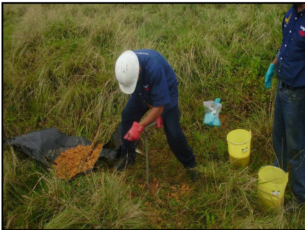
Foto 18. Toma de muestra en sondeo SB-9.
