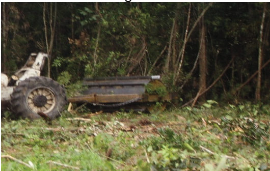
7- Picado de vegetación con rodillo cuchillo
