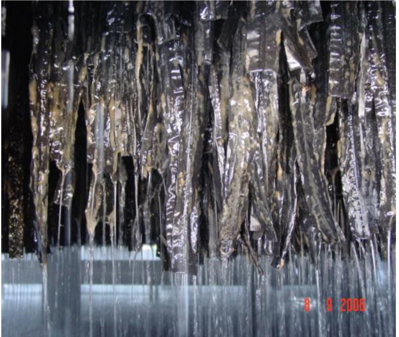
Ci-dessus : le lit bactérien à ruissellement sessil (prototype)
