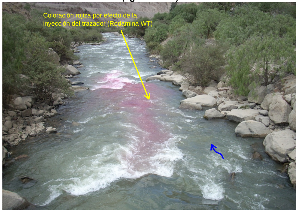
Foto 2-1 Vista aguas abajo del río Huaura luego de la inyección del trazador Rodamina, desde el puente carrozable hacia los Baños Termales Cabracancha (agosto 2008)
