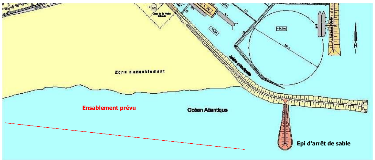
Figure 3: Situation avec l'épi d'arrêt de sable
