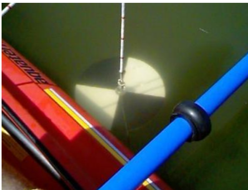
Figura 9: Medición con disco Secchi
