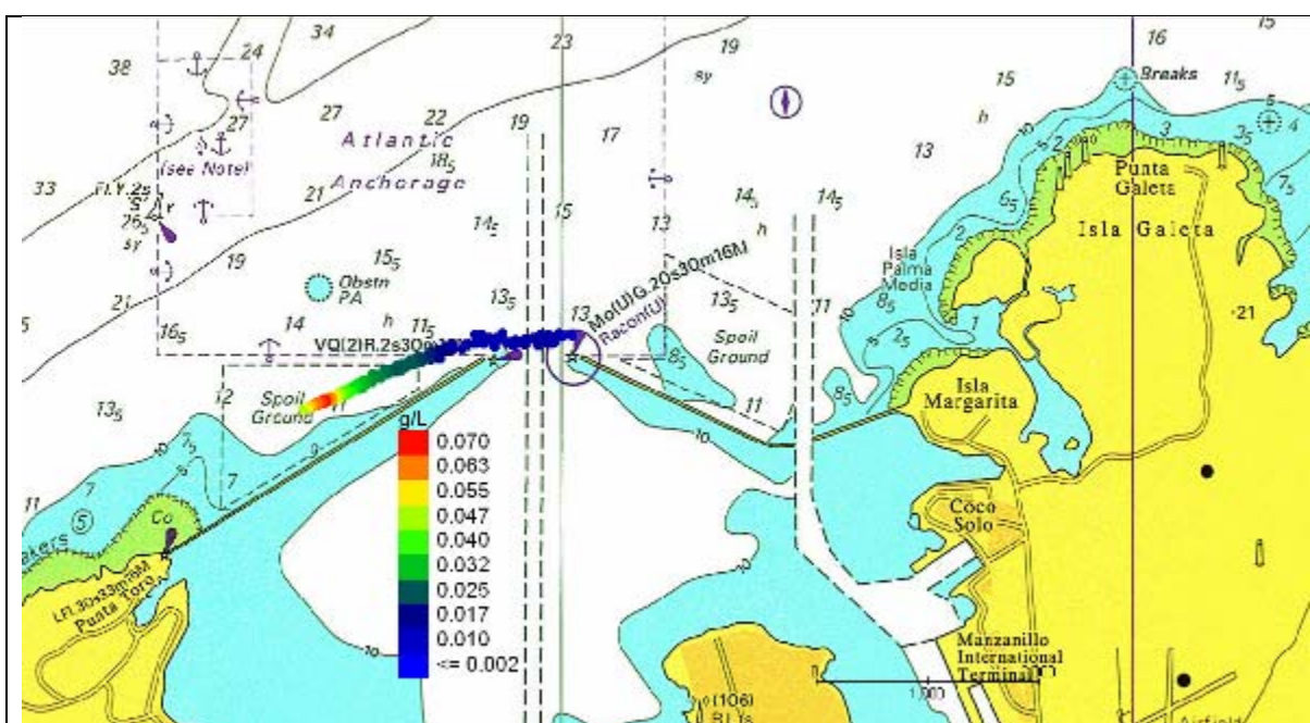
Figura 19 Escenario 2. Rompeolas Oeste. Detalle de las concentraciones de los sólidos en la columna de agua a las 12 horas desde el comienzo del depósito.
