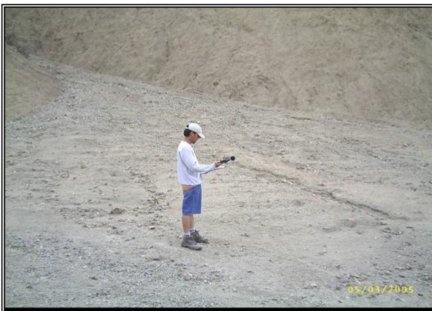
Foto 8 Medición de ruidos en la Cantera GNL2 Punto. 2. Marzo 2005.
