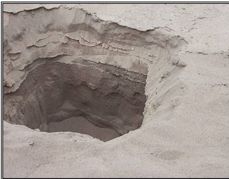
Foto 2 En la calicata ubicada en una planicie cerca de la entrada de la quebrada Culebrilla, se puede apreciar capas de arenas eólicas, sueltas, subhorizontales, con algunos horizontes de limos.
