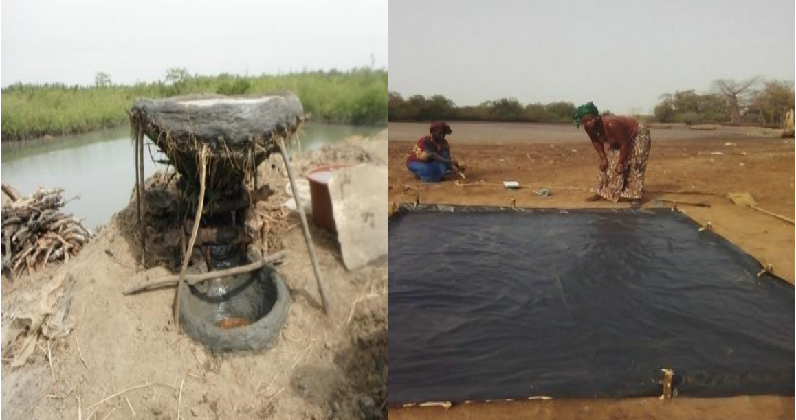
Filtre pour recueillir la saumure (eau avec une forte teneur en sel) et bâche posée par des productrices encadrées
